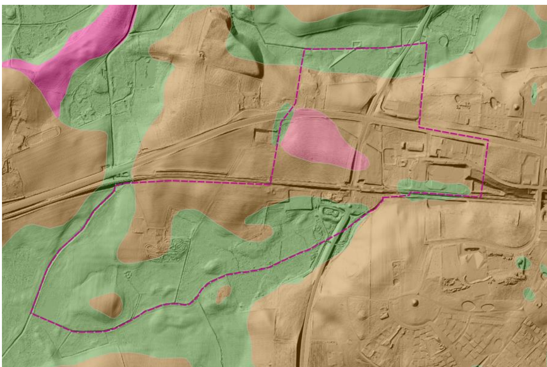
Figur 4.3. Jordarter i undersøgelsesområde ved Kildedal (stiplet lilla linje). Grøn: Ferskvandstør (FT, postglacial), rosa: Smeltevandssand (DS, glacial), brun: Moræneler (ML, glacial), pink: Smeltevandsgur (DG, glacial) /13/. Baggrundskort er fra Geodatastyrelsen, DHM/Terræn skyggekort overdrevet, WMS-tjeneste.
